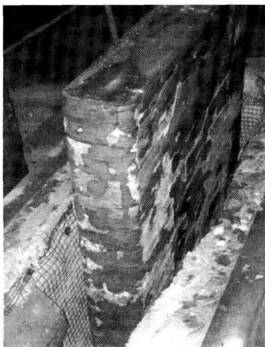
图 1 2205 双相不锈钢 6.2 t 电渣重熔扁锭形貌
